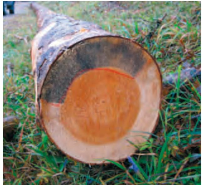
*Hagelschäden an einem Föhrenstamm (Bläuepilzbefall)*
